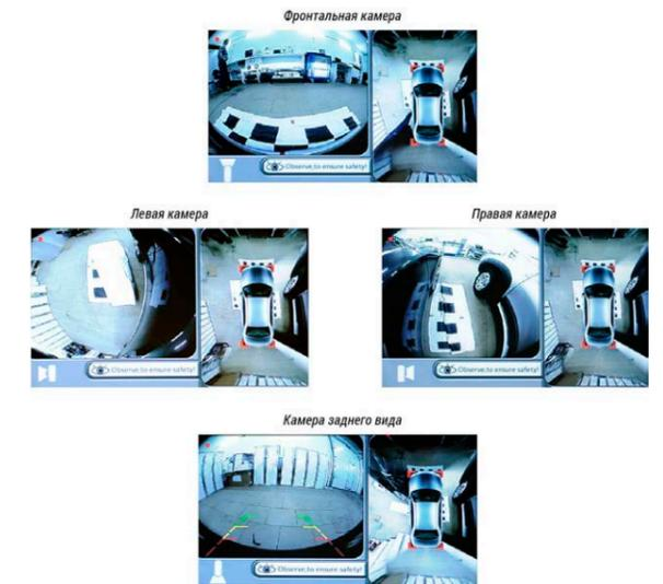
Высокопроизводительный процессор управляет 4-мя камерами с широкими углами обзора 180°, а встроенный видеорегистратор позволяет фиксировать запись с помощью экономичного и качественного кодека H264. Запись может производиться с одной камеры по выбору пользователя системы или со всех 4 одновременно.
