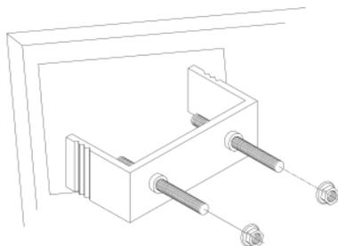
Используйте кронштейн и винты, для фиксации устройства. Установите U-образный кронштейн за устройством, используя две гайки для крепления.
