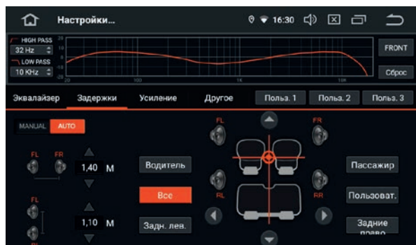
Автоматическая настройка временных задержек
